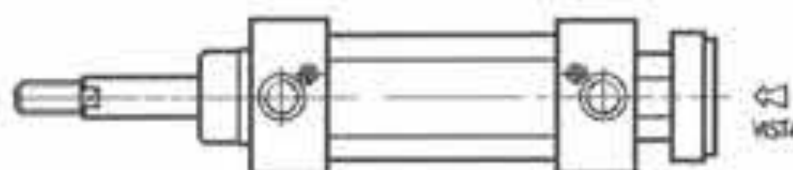
ESECUZIONE ASTE GEMELLATE PASSANTI
